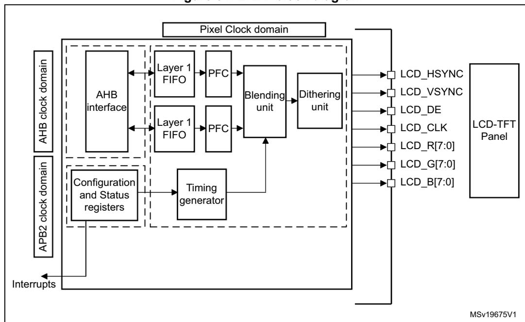
Layer FIFO: One FIFO 64x32 bit per layer.
